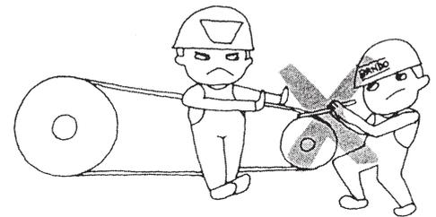
Die Scheiben sollten auf gute Fluchtung ausgerichtet werden. Ebenso ist die Wellenparallelität zu prüfen. Folgende Werte gilt es einzuhalten:
