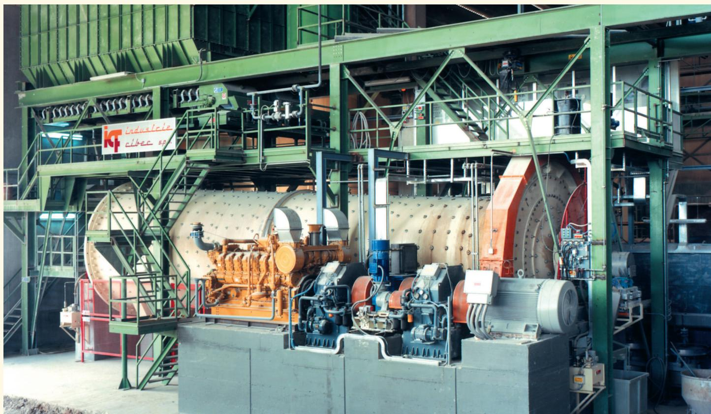
2x34 KSL, 630 кВт - 1000 об/мин. Привод мельницы (Италия)
