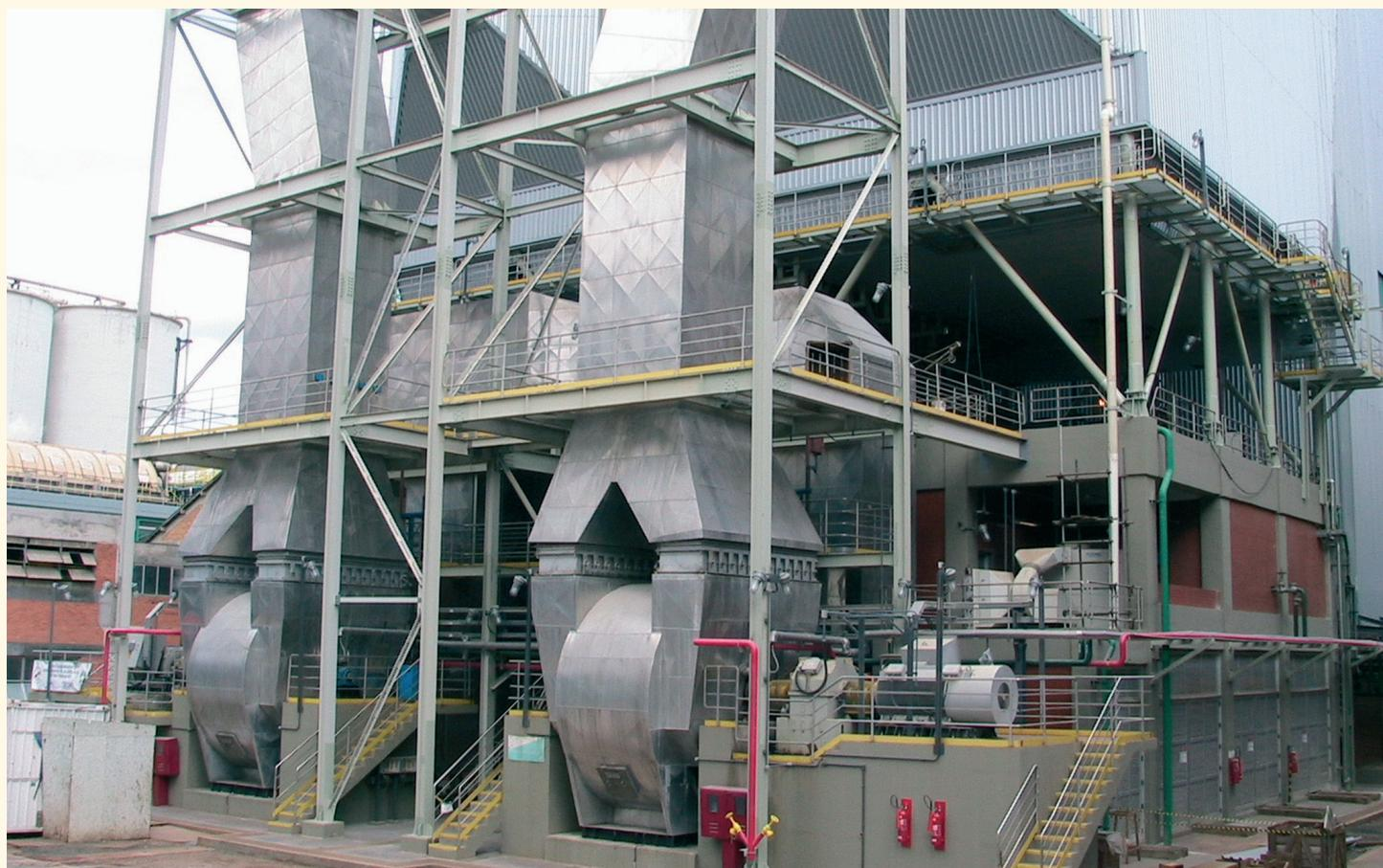
2x34 KSL, 2000 кВт - 1200 об/мин. Привод вентилятора (Бразилия)
